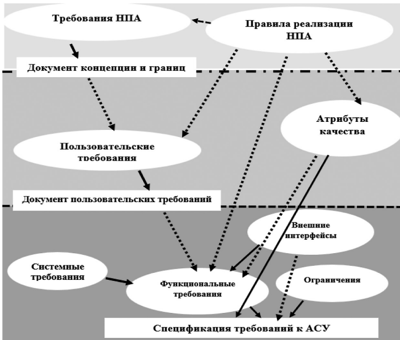
Рис. 1. Взаимосвязи нескольких типов информации для требований. Сплошные линии означают «содержатся в», а пунктирные – «являются отправной точкой» или «вливают на»
